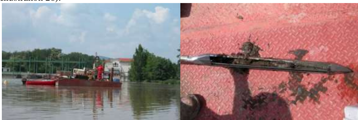
Illustration 26. Barge sur Labarre et prélèvement avec un carottier à gouge (MIGADO ©)
