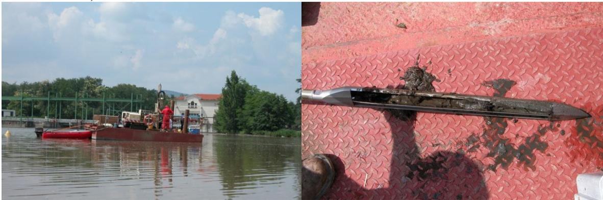
*Illustration 10. Barge sur Labarre et prélèvement avec un carottier à gouge (MIGADO ©)*
