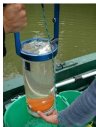
Illustration 35. Matériel de prélèvements (filet à phytoplancton), matériel de mesures (MIGADO ©)
