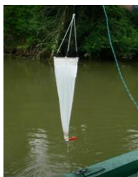
Illustration 35. Matériel de prélèvements (filet à phytoplancton), matériel de mesures (MIGADO ©)
